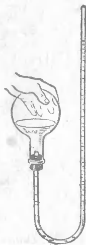
Рис. 124. При нагревании ру- кой воздух в колбе расши- ряется, и жид- кость в трубке заметно под- нимается.
