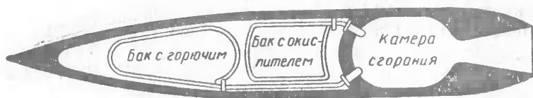
Рис. 141. Схема жидкостно-реактивного двигателя.
