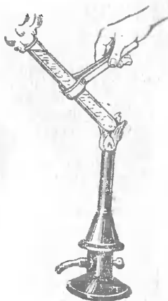
Рис. 128. При нагревании воды снизу тепло передается вследствие конвекции.
